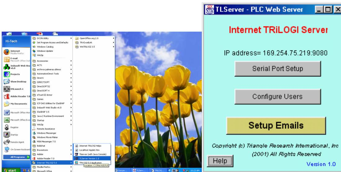
Luego de estar ubicado en esta ventana, hacemos click sobre el botón llamado “Serial Port Setup” y verificamos los datos de comunicación. En el recuadro command string escribimos IR\* y el PLC nos responderá con el comando IRxx, donde xx es la dirección del PLC.
